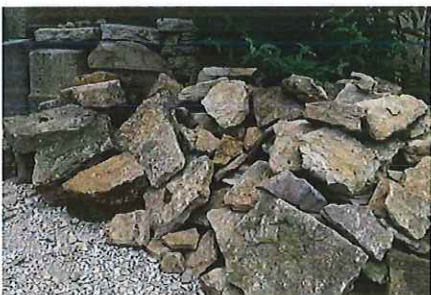
La dépose et le stockage des matériaux anciens est un atout pour la reconstruction respectueuse du bâti d'origine.
