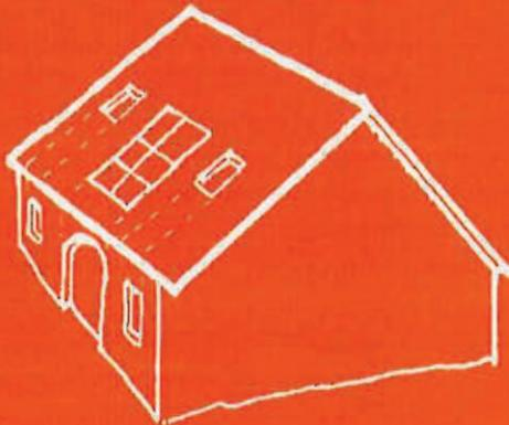
Les fenêtres de toit et panneaux solaires sont ordonnancés dans un projet d'aménagement global des combles, et reprennent les alignements des ouvertures en façades.
